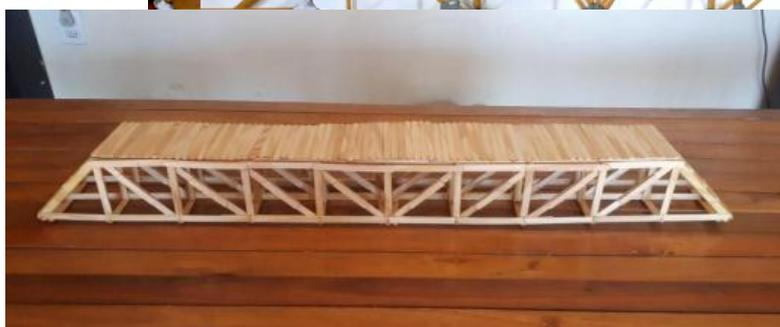
Figura 2: Ponte de palito de picolé finalizada
